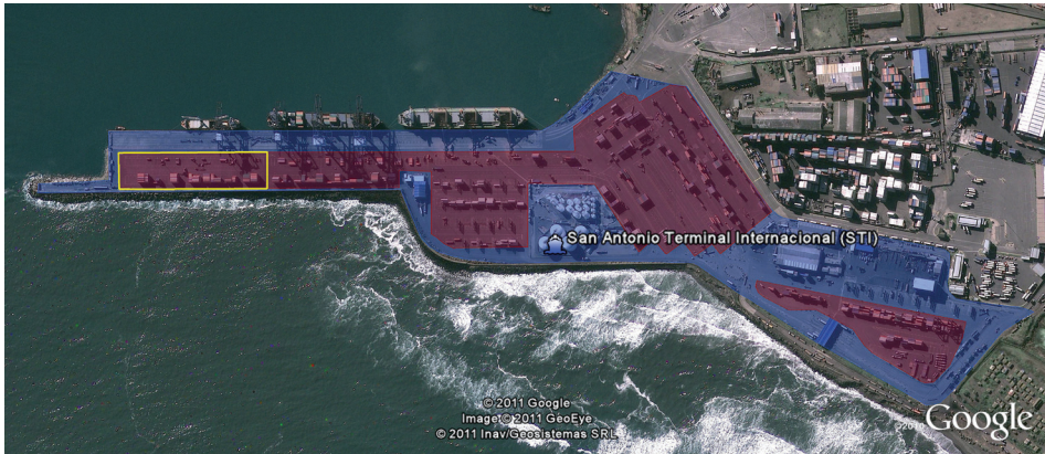
Figura 44. Área de patio de reachstackers en San Antonio Terminal Internacional (San Antonio - Chile)
