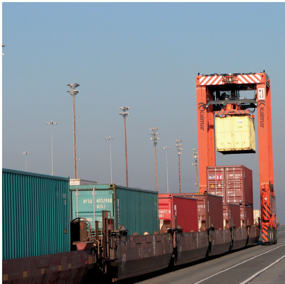
Figura 106. Straddle carriers operando sobre ferrocarril
