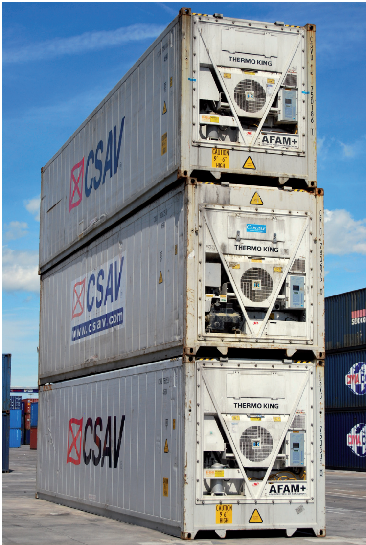
Figura 147. Contenedores refrigerados (reefers)
