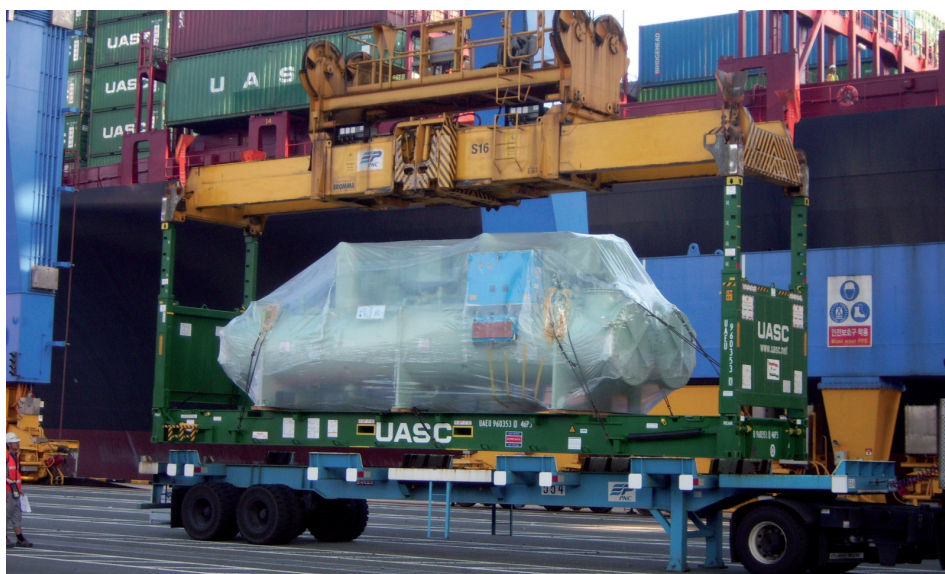
Figura 143. Super Racks con postes extendidos
