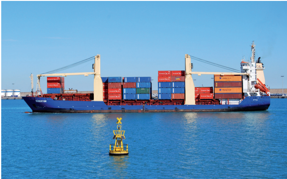
Figura 70. Buque portacontenedores con grúas de buque
