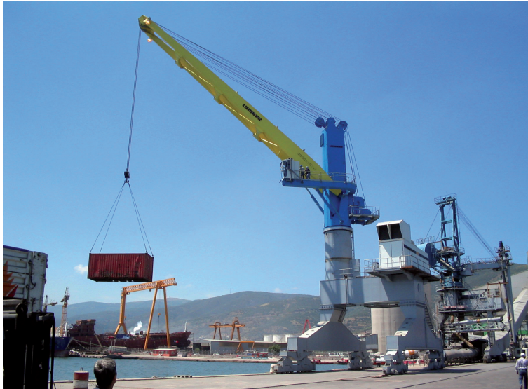
Figura 67. Grúa móvil Liebherr adaptada para carriles
