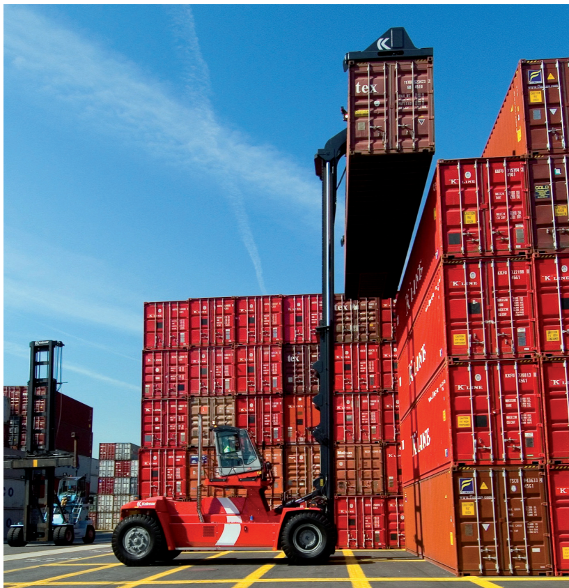
Figura 85. Cabina basculante para mejorar la visibilidad
