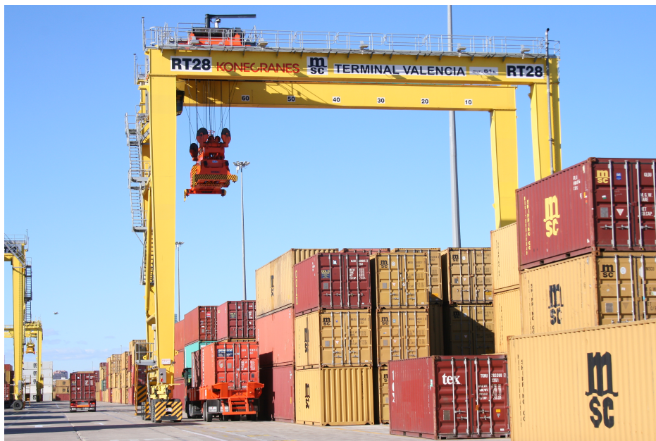
Figura 107. Recepción de camión con RTG
