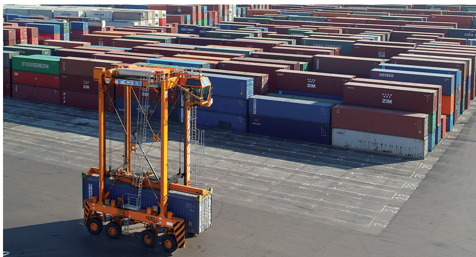
Figura 91. Straddle carrier en patio de terminal
