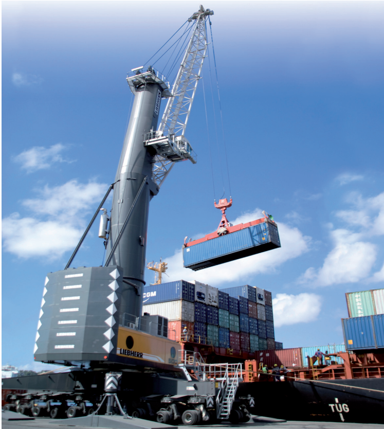
Figura 51. Grúa móvil Liebherr
