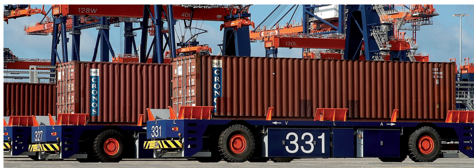
Figura 119. AGVs en Euromax Terminal. Puerto de Rotterdam (ECT)
